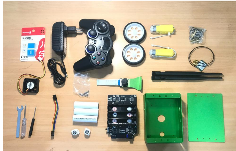
Gambar 3.3 Komponen Waveshare JetBot AI Kit
