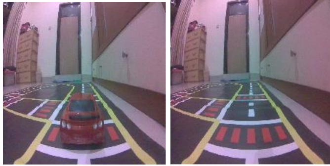
Gambar 3.10 Bentuk Pengambilan gambar “Free” dan “Blocked”
