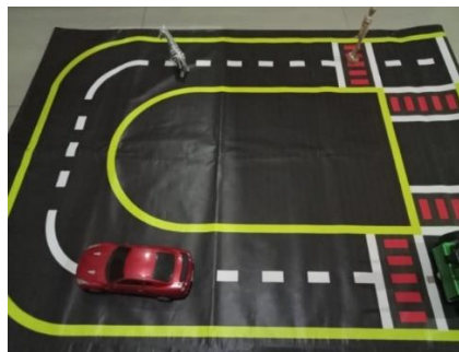
Gambar 4.1 Nvidia JetBot pada uji penggabungan fungsi Collision Avoidance dan Road Following dengan kondisi pencahayaan terang
