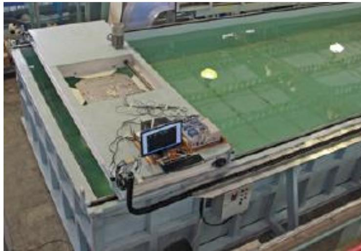
**Gambar 2.25** Towing Tank untuk Eksperimen
