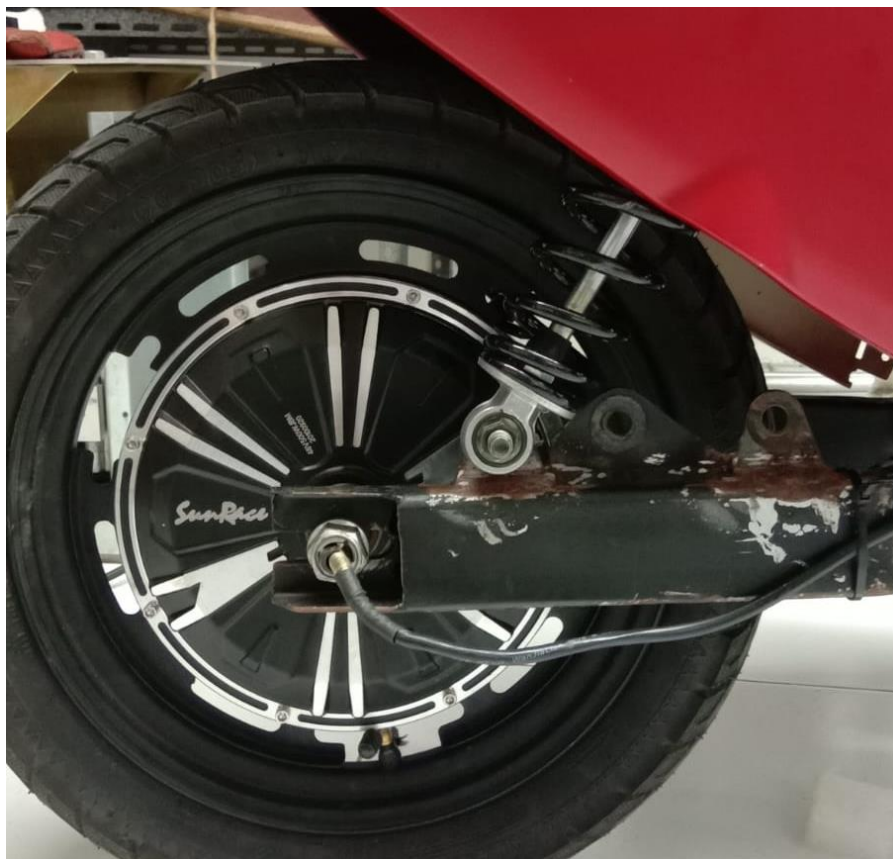
Gambar 4.8 Posisi Shock Absorber RSA pada Variasi Posisi Dudukan Suspensi C
