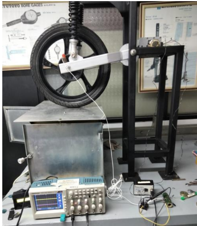
Gambar 2.3 Pengujian RSA pada table shaker [9]
