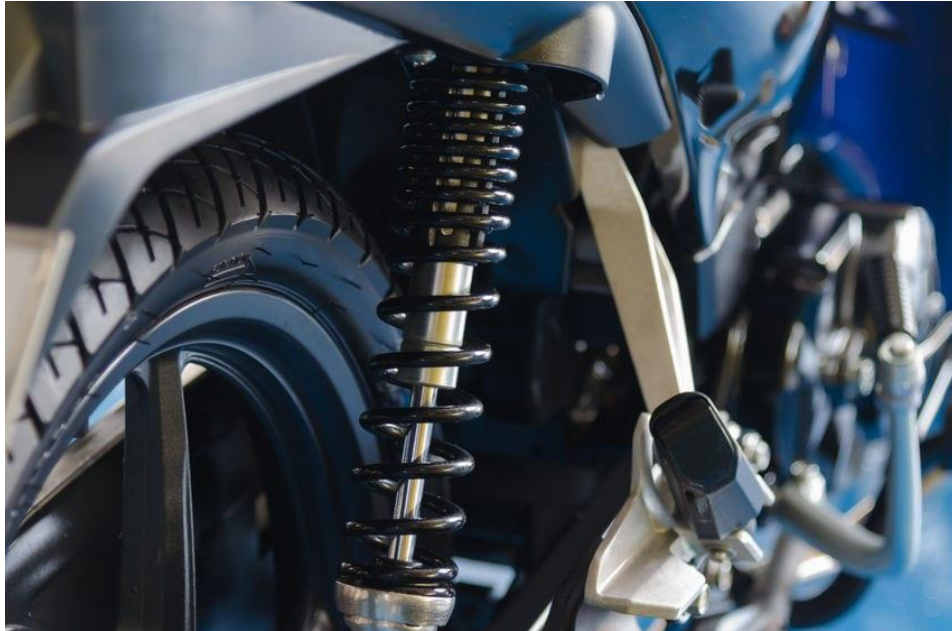
Gambar 2.10 Suspensi pegas dan peredam pada sepeda motor (suzuki.co.id)
