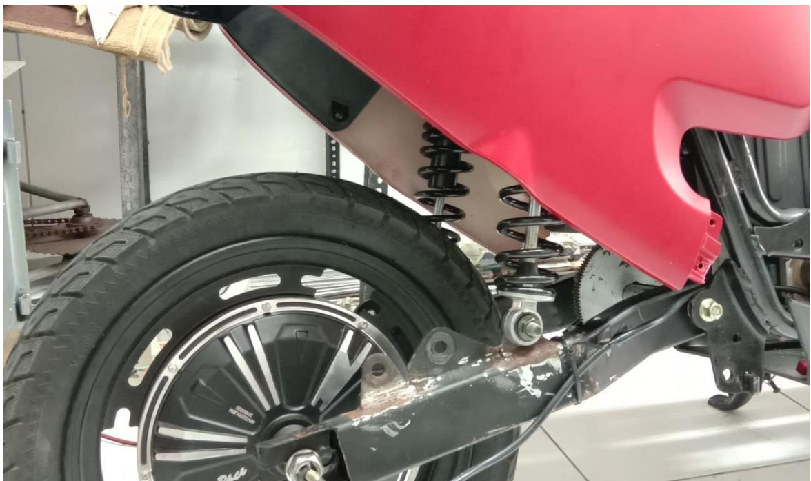
Gambar 4.6 Posisi Shock Absorber RSA pada Variasi Posisi Dudukan Suspensi A
