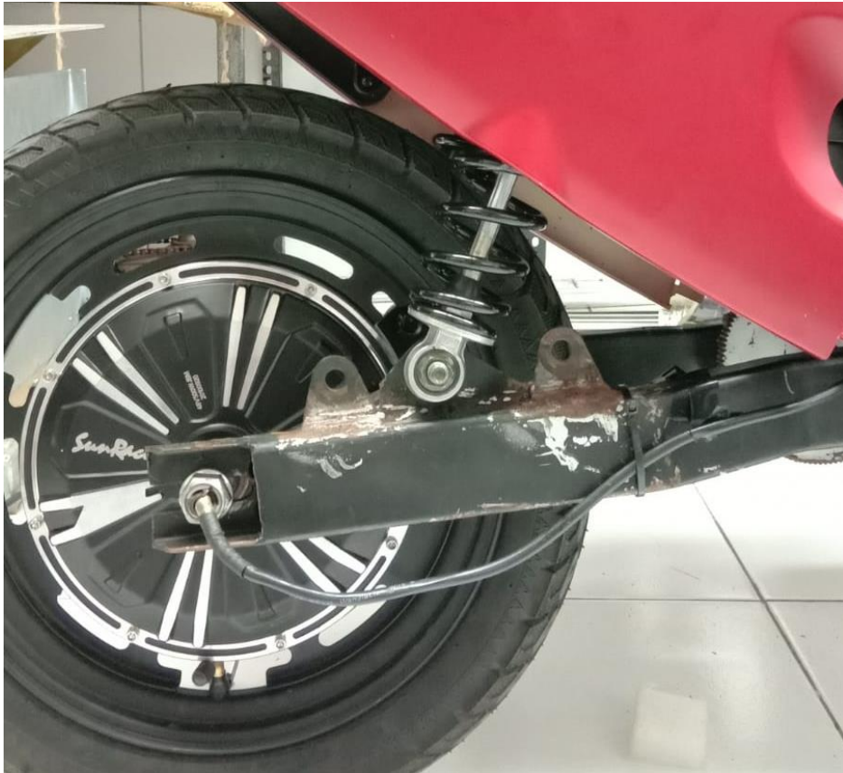
Gambar 4.7 Posisi Shock Absorber RSA pada Variasi Posisi Dudukan Suspensi B
