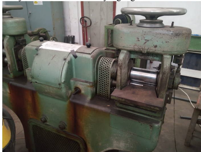
Gambar 3. 7. Mesin Rolling Mill
