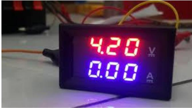
Gambar 3.8 Amperemeter dan Voltmeter
