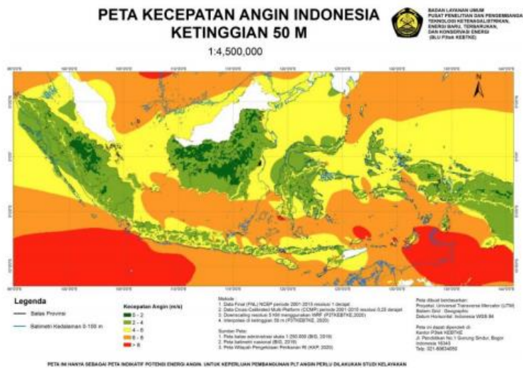
Gambar 2.1 Peta Distribusi Kecepatan Angin Onshore dan Offshore di Indonesia (Badan Layanan Umum p3kebt, 2021)
