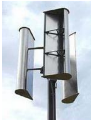
Gambar 2. 6 Desain profil turbin angin tipe Lenz 2 (Zwierzchowski et al, 2017)
