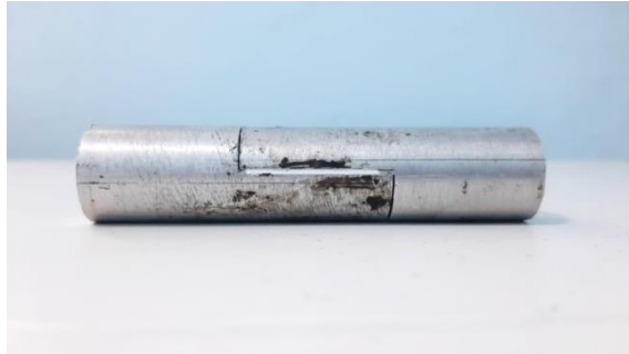
Gambar 3.2 Bentuk asli dari spesimen uji sambungan adhesive tipe single lap
