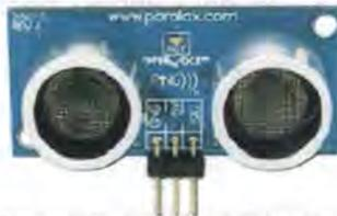
Gambar 3.3 Sensor ultrasonik<sup>[2]</sup>
