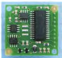
Gambar 3.5 Modul kompas CMPS03<sup>[2]</sup>
