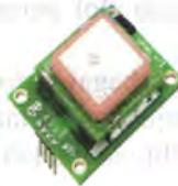
Gambar 3.7 GPS Module PMB-648<sup>[2]</sup>
