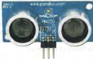
Gambar 2.5 Sensor Ultrasonik<sup>[2]</sup>
