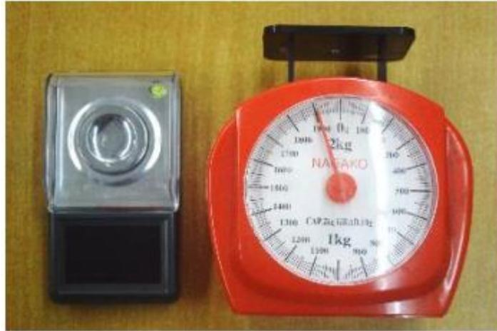
**Gambar 3.10** Timbangan Beban dan Timbangan Digital
