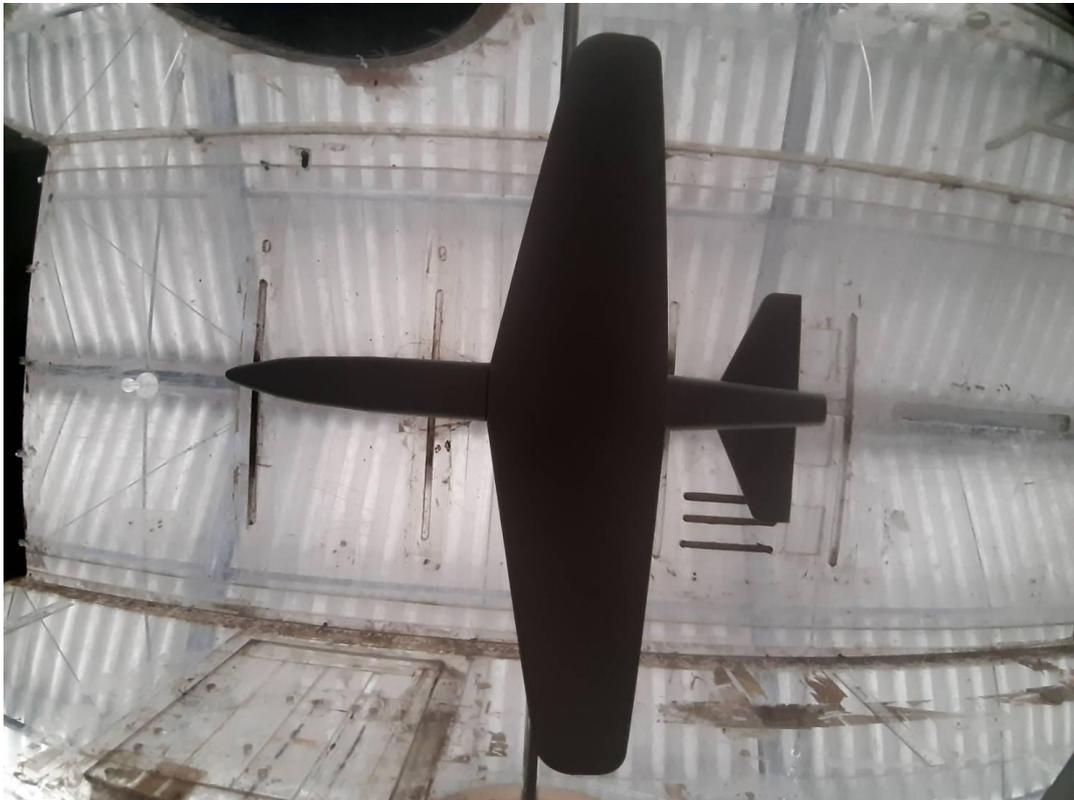
Gambar 4 Pengujian model P pada terowongan angin
