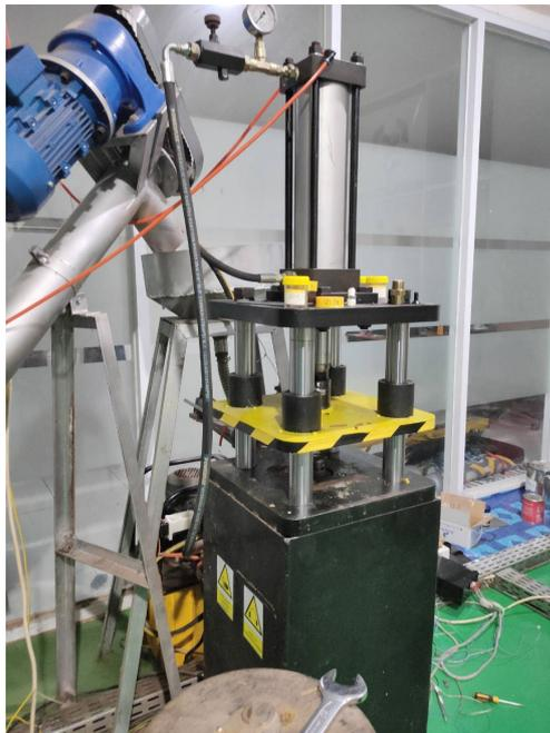
Gambar 3.6 Mesin Kompaksi
