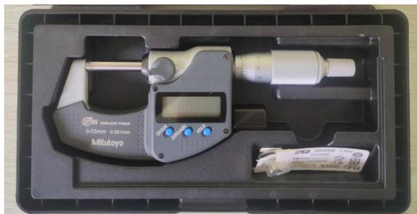
Gambar 3.7 Mikrometer Sekrup
