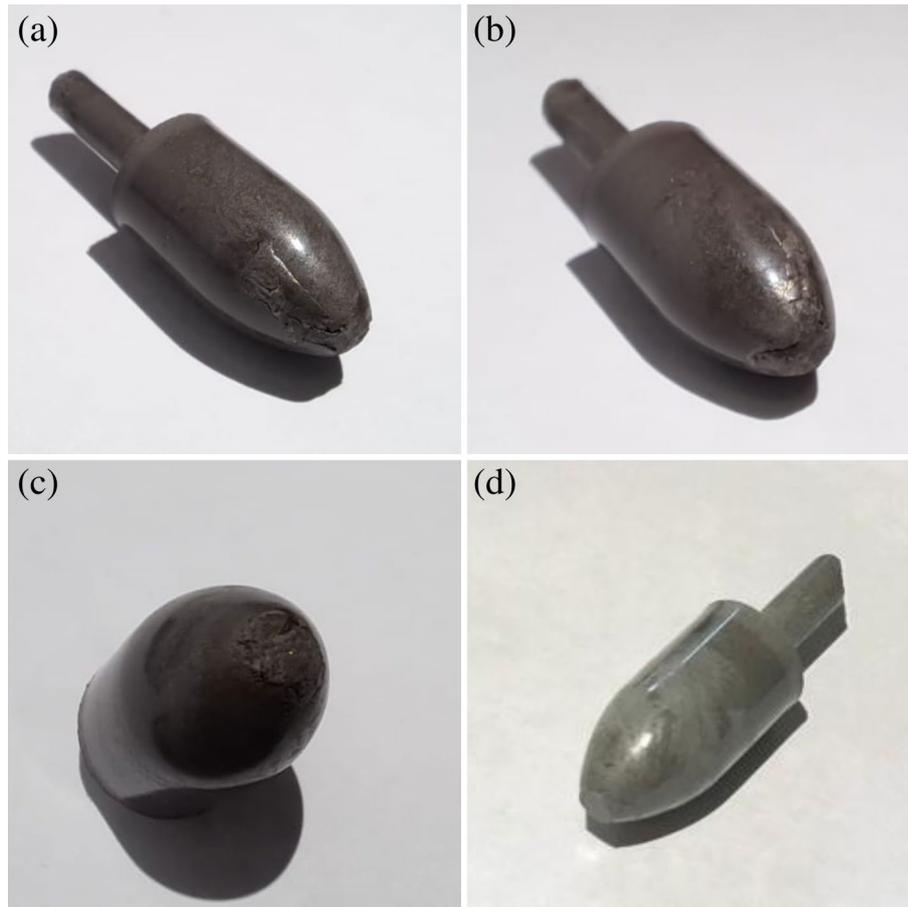
**Gambar 4.3** (a) Temperatur Leleh 230 °C, Temperatur Cetakan 60 °C. (b) Temperatur Leleh 230 °C, Temperatur Cetakan 70 °C. (c) Temperatur Leleh 240 °C, Temperatur Cetakan 70 °C. (d) Temperatur Leleh 240 °C, Temperatur Cetakan 90 °C.
