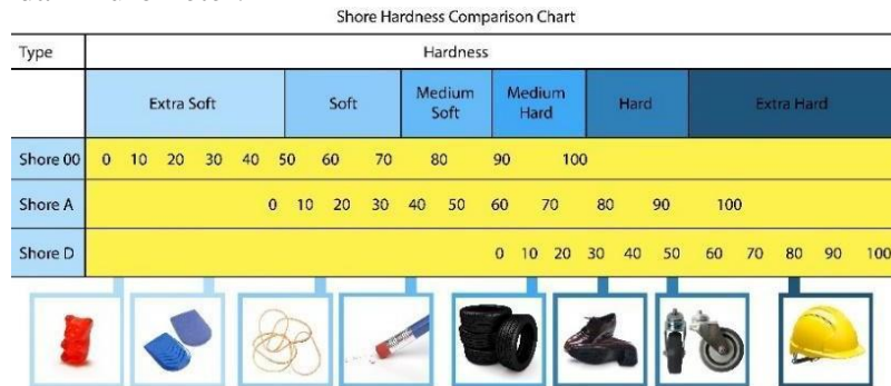
Gambar 2.6 Skala Kekerasan pada Durometer(Hidayat et al., 2016)
