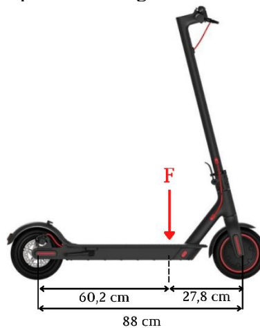
Gambar 3.12 Free body diagram pada skuter
