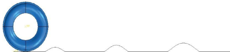
Gambar 2.32 Assembly komponen ban dengan model polisi tidur (Hidayat et al., 2016)
