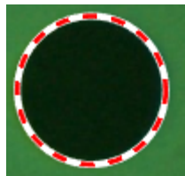
Gambar 4.12 Hasil Deteksi Lingkaran Pada Bekas Pin Proses FSW
