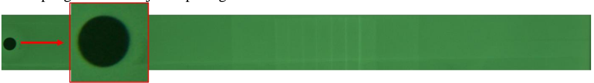
Gambar 4.11 Lingkaran Bekas Pin Pada Proses FSW
