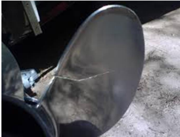
Gambar 2. 4 Crack pada propeller kapal (Djazuli Sa'id, 2012)
