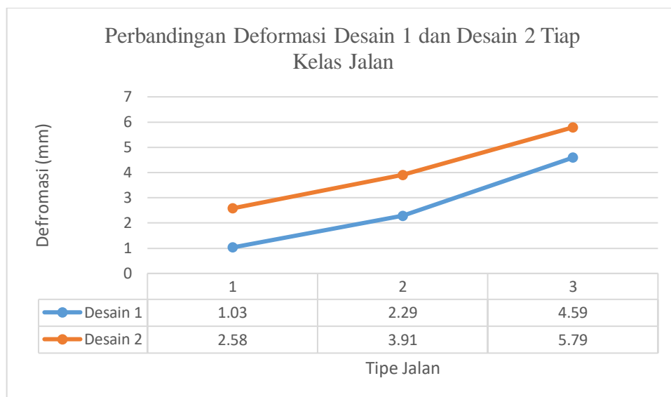
Gambar 4.59. Grafik Perbandingan Deformasi pada Desain 1 dan Desain 2 untuk Tiap Kelas Jalan
