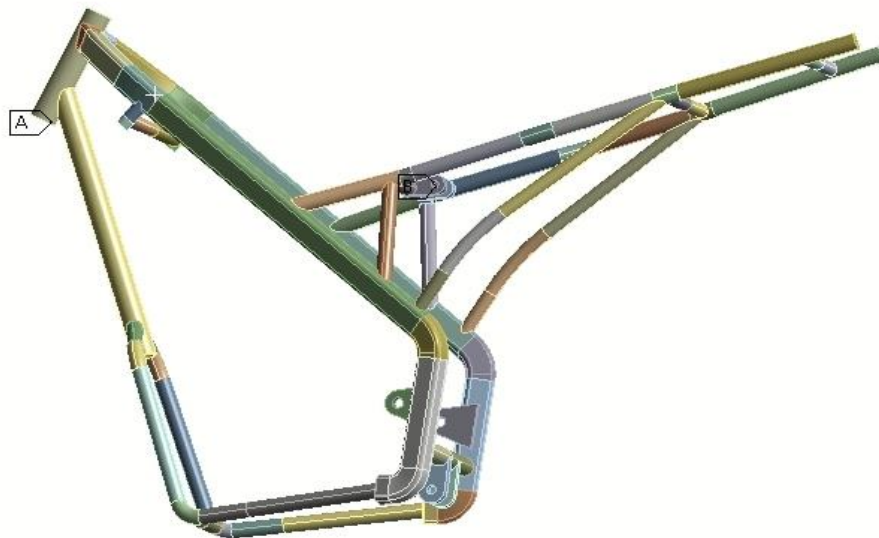
Gambar 4.44. Boundary condition pembebanan simulasi random vibration Desain Pertama
