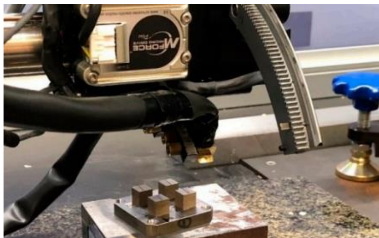
Gambar 2.16 Alat ukur deformasi dengan teknik difraksi sinar-X (XRD)
