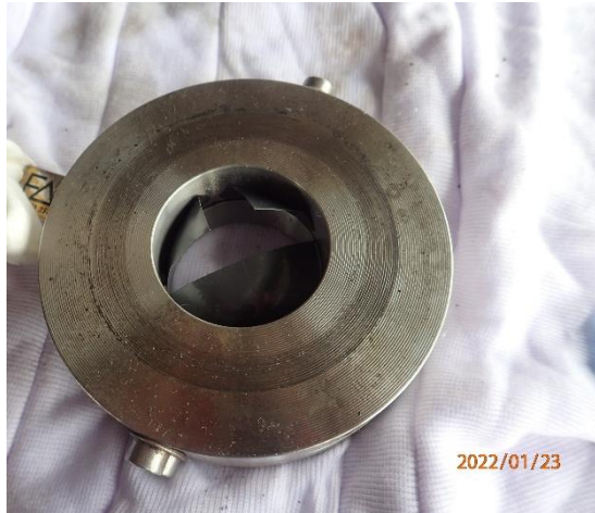
Gambar 1.6 Temuan Rupture Disc Failure tanggal 23 Januari 2022
