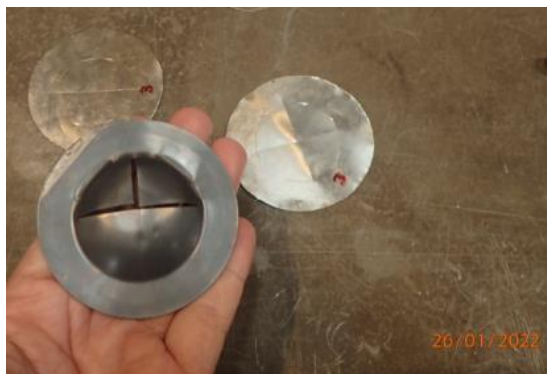
Gambar 1.7 Temuan Rupture Disc Failure tanggal 26 Januari 2022
