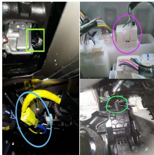
**Gambar 2.9** Contoh cacat konektor *halflock*
