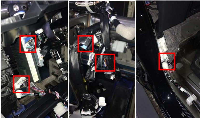
**Gambar 2.7** Contoh konektor elektrik pada line perakitan
