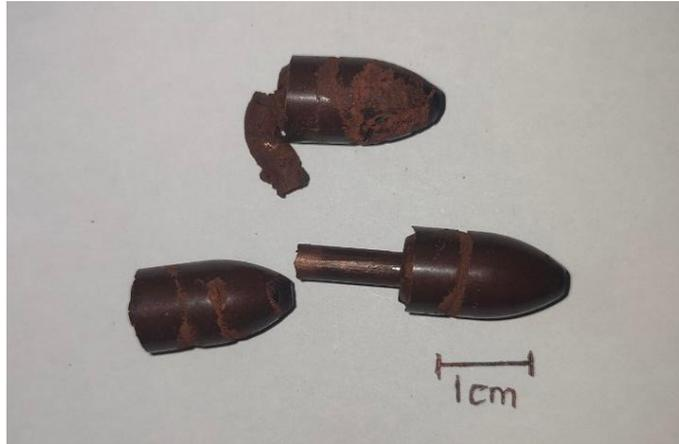
**Gambar 4.3** Kecacatan pada Proyektil Hasil Injeksi
