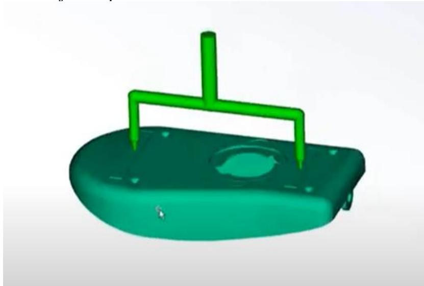
**Gambar 2.8** Ilustrasi Autodesk Moldflow Adviser 2019 Setelah Melakukan *Input* Geometri Produk, Desain Cetakan, dan Jenis Material (Autodesk, 2019)
