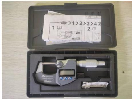
**Gambar 3.9** Mikrometer Sekrup yang Digunakan
