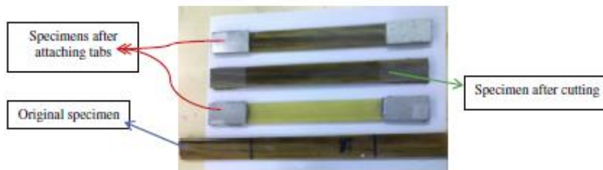
Gambar 2.27 Spesimen Komposit Kenaf-Epoksi
