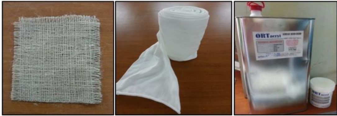
Gambar 2.23 Bahan yang digunakan dalam penelitian ini (a) Serat jute (b) Serat perlon (c) Resin PMMA (Jumaah & Oleiwi, 2016)
