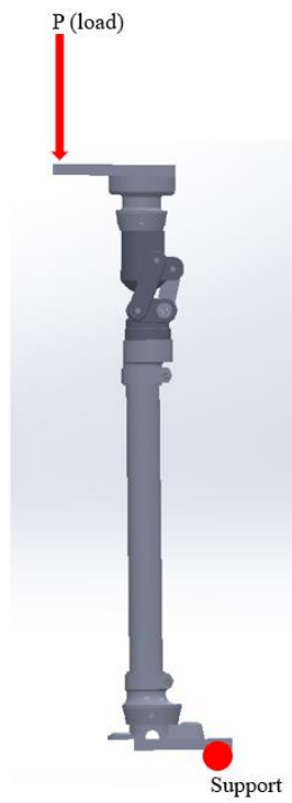
Gambar 3.6 Boundary condition pada condition 1
