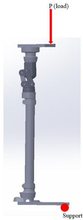
Gambar 3.7 Boundary condition pada condition 2
