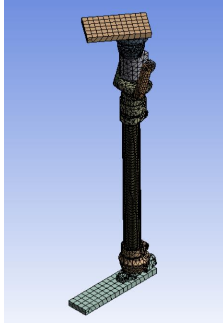
Gambar 3.23 Mesh pada kaki palsu
