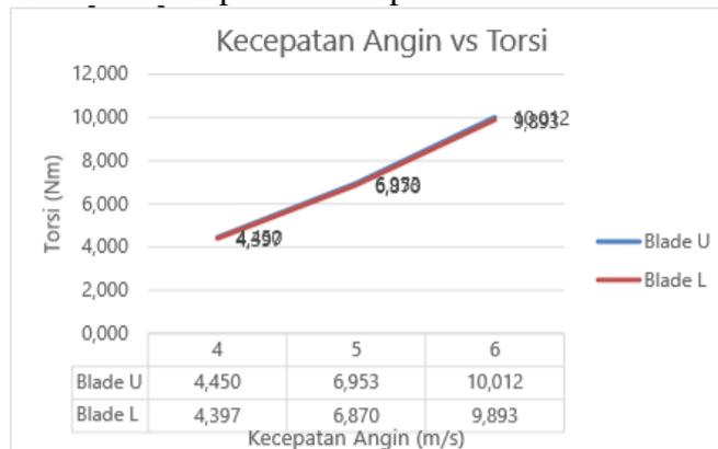
**Gambar 2. 27** Grafik Torsi (Nm) terhadap kecepatan udara (m/s) (Setyawan, 2018)
