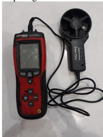
**Gambar 3. 19** *Anemometer*
