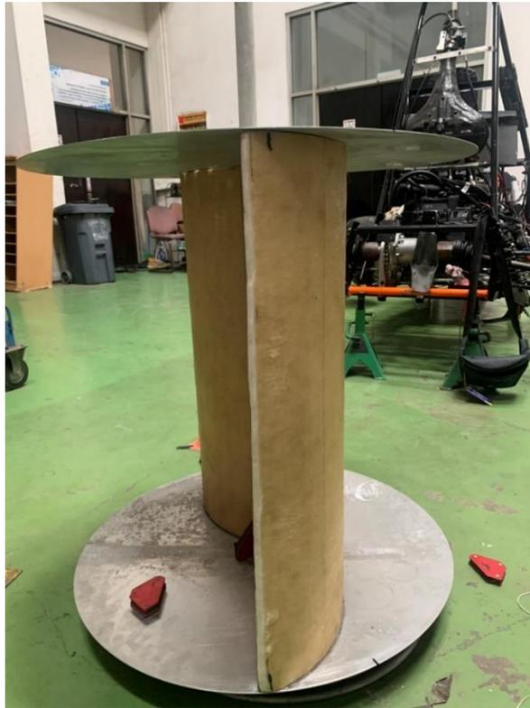
**Gambar C. 1** Proses Penempelan Sudu Turbin Savonius dengan *endplate*
