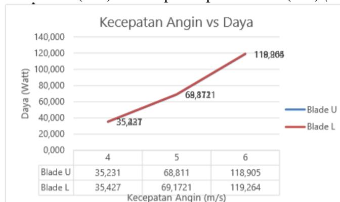
**Gambar 2. 28** Grafik Daya (Watt) terhadap kecepatan udara (m/s) (Setyawan, 2018)
