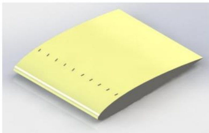
Gambar 2.20 Konfigurasi vortex generator pada model dalam penelitian (Aji, 2020)
