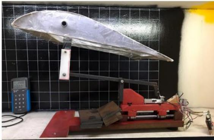
Gambar 2.18 Model terpasang pada aerodynamic scale untuk pengujian wind tunnel (Neto, et al., 2020)
