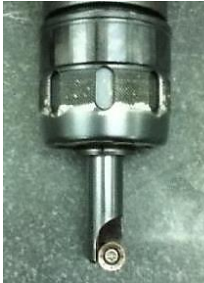
Gambar 3. 2 Pahat ball nose end mill (Kasim et al., 2015)
