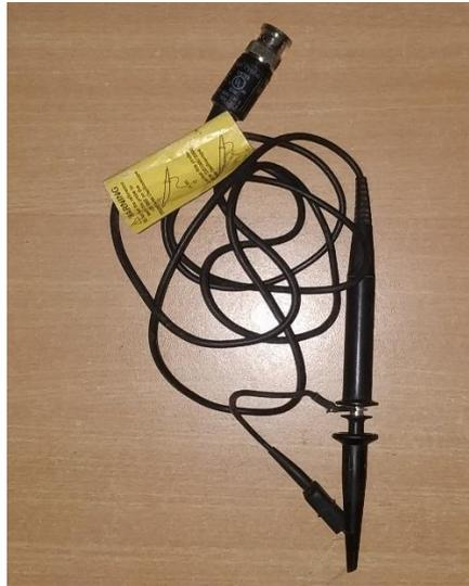
**Gambar 3.27** *Probe* Tegangan
