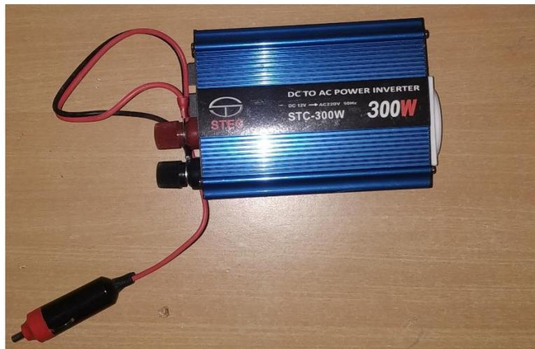
**Gambar 3.24** *Inverter* Tegangan DC ke AC
