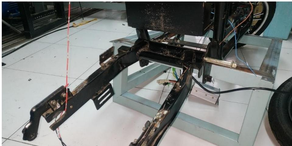
**Gambar 3. 17** Lokasi pemasangan *Regenerative swing arm* pada Volta 302
