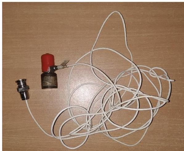
**Gambar 3.26** *Accelerometer*
