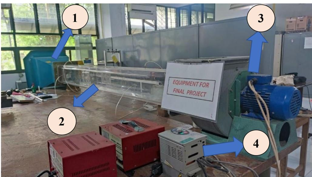
Gambar 3. 2 Susunan Wind Tunnel
