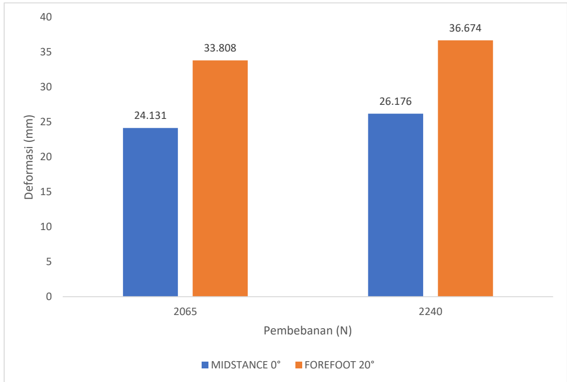
Gambar 4. 42 Grafik Perbandingan antara Pembebanan 2065 N dan 2240 N menggunakan material Sisal/Epoxy pada ketebalan 35 mm terhadap deformasi
