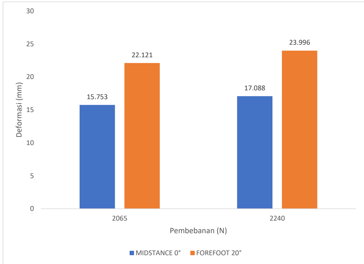
Gambar 4. 48 Grafik Perbandingan antara Pembebanan 2065 N dan 2240 N menggunakan material Sisal/Epoxy pada ketebalan 40 mm terhadap deformasi
