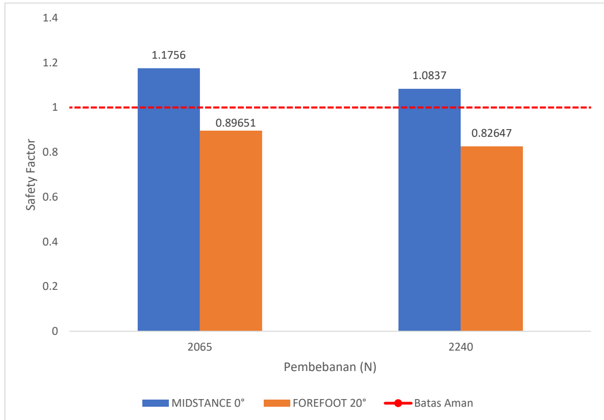
Gambar 4. 46 Grafik Perbandingan antara Pembebanan 2065 N dan 2240 N menggunakan material Palem/Epoxy pada ketebalan 35 mm terhadap safety factor
