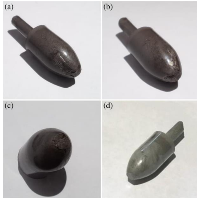
Gambar 4.5 (a) Temperatur Leleh 230 °C, Temperatur Cetakan 60 °C. (b) Temperatur Leleh 230 °C, Temperatur Cetakan 70 °C. (c) Temperatur Leleh 240 °C, Temperatur Cetakan 70 °C. (d) Temperatur Leleh 240 °C, Temperatur Cetakan 90 °C.
