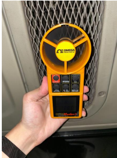
Gambar 3. 11 Anemometer yang Digunakan dalam Pengukuran Kecepatan AC ELF
