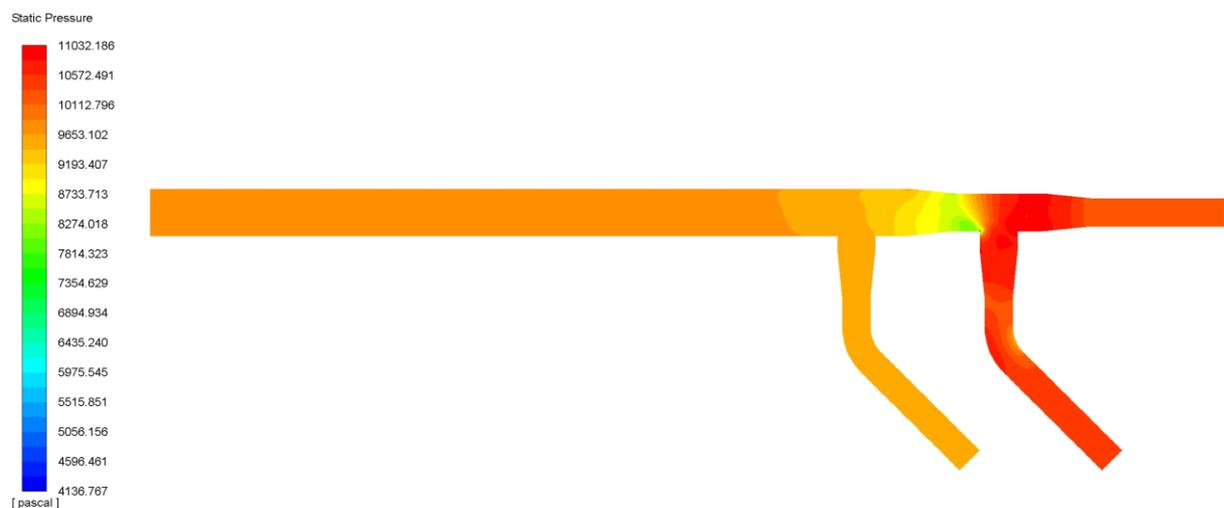
**Gambar 4. 11** Kontur tekanan statis pada kondisi *inlet-1* dan *inlet-2* terbuka
