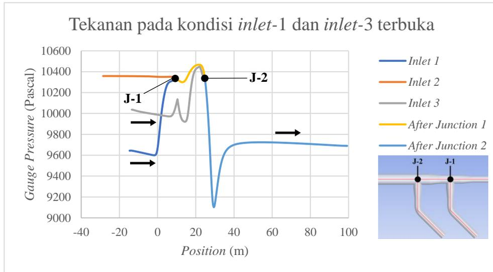
**Gambar 4. 18** Grafik perbandingan tekanan pada tiap *inlet* ditinjau dari tengah penampang pada kondisi *inlet-1* dan *inlet-3* terbuka
