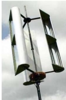
**Gambar 2. 6** Ilustrasi bentuk VAWT tipe Lenz 2 (Nishioka, et al 2018)
