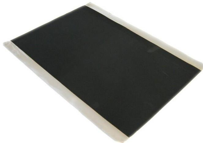
**Gambar 3.9** Aluminium NMC532 yang digunakan Sebagai Katoda
