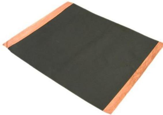
**Gambar 3.10** *Copper Coated Graphite* yang digunakan sebagai Anoda
