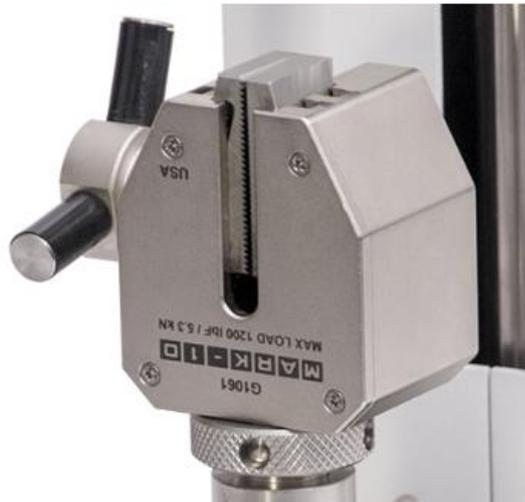
**Gambar 3.5** Chuck untuk Tensile test
