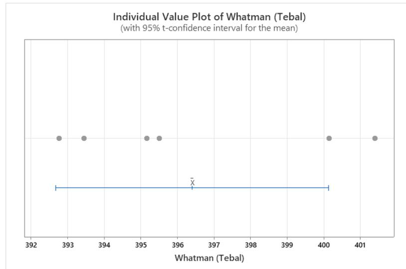
**Gambar 4.4** Grafik Hasil Pengukuran Ketebalan Pengujian Pertama *Separator* Whatman. Menunjukkan Banyak Sampel berada diluar *Confidence Interval*
