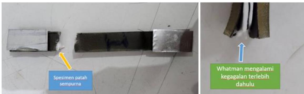
**Gambar 4.31** Kegagalan pada Baterai dengan *Separator* Whatman
