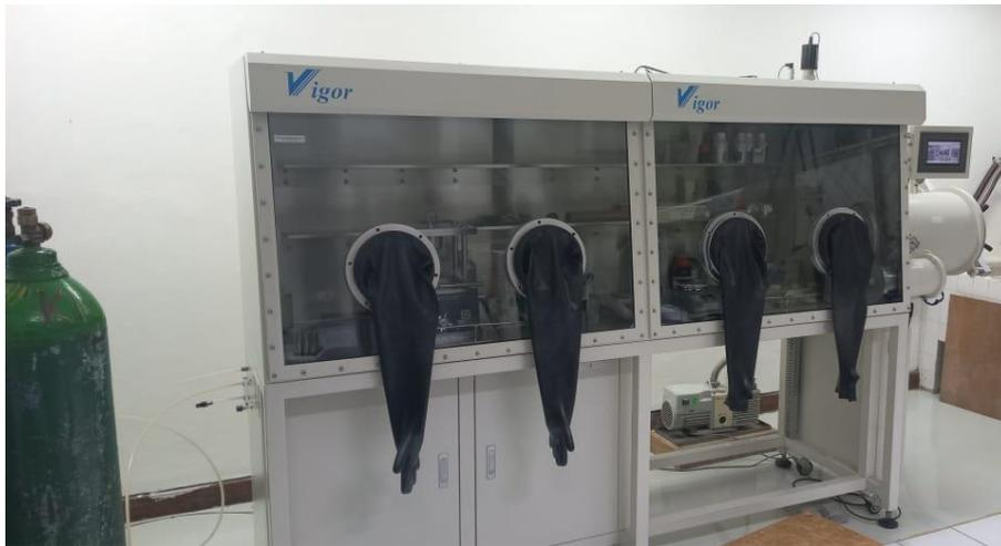
**Gambar 3.7** Glovebox untuk pembuatan spesimen pouch cell (P2 Fisika Puspiptek, Serpong)
