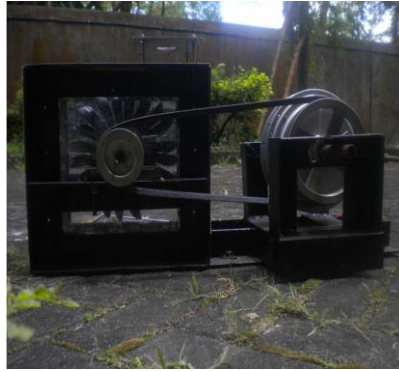
Gambar 2. 12 Alat yang digunakan dalam eksperimen (blade, piringan, runner, poros, nozzle, rumah turbin)
