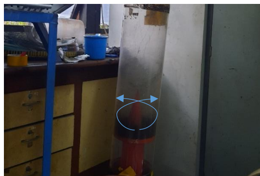
Gambar 2. 28 Penggunaan Drying Bed Single Row Blade
