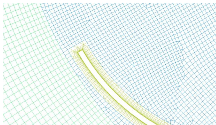
Gambar 3.5 Tampilan gambar meshing turbin angin Savonius konvensional di sekitar sudu
