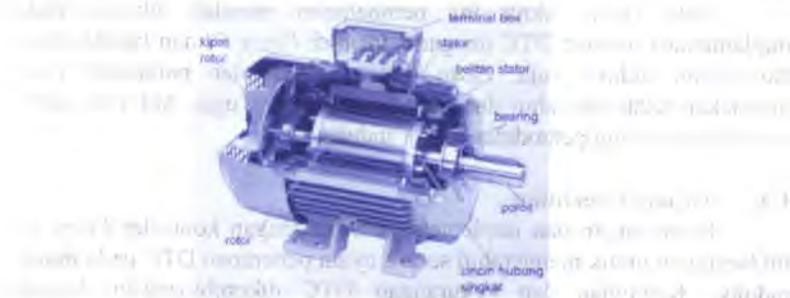
**Gambar 1.1** Konstruksi dari motor induksi
