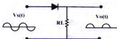
**Gambar 2.18** rangkaian penyearah setengah gelombang
