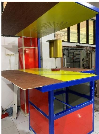
**Gambar 3.8** Penyangga Turbin Savonius
