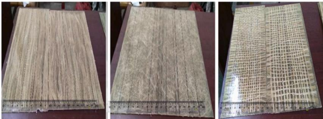
Gambar 2.1 Konfigurasi Komposit Kenaf (Fajrin, Akmaludin, & Gapsari, 2022)
