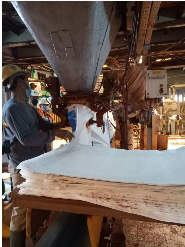
Gambar 2.1 Proses Clamping (Sumber: Dokumentasi Perusahaan)
