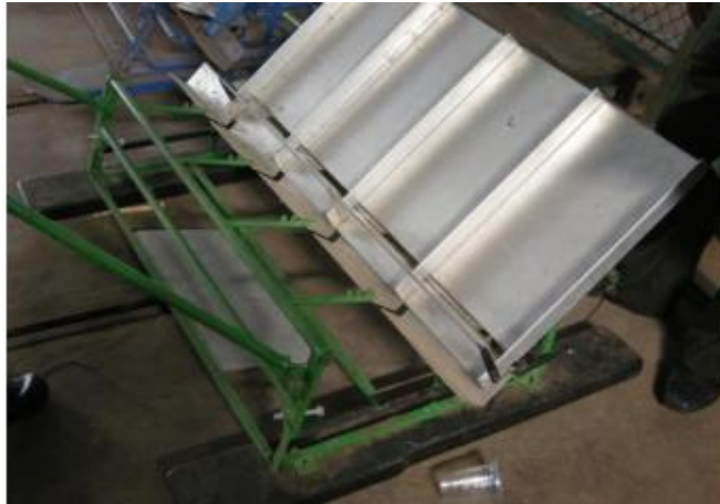
Gambar 2. 2 Mesin Penanam Padi Berefisiensi 86,79% (Sumber : Hernel 2016)
