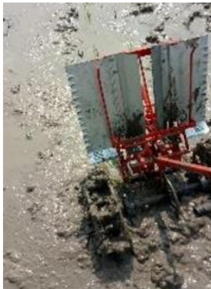
Gambar 2. 1 Mesin Penanam Padi Sistem Rasio Putaran Roda (Sumber : Ananda Trisukmo Utomo 2017)
