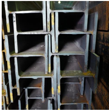
Gambar 2.6 Profil Baja H beam
