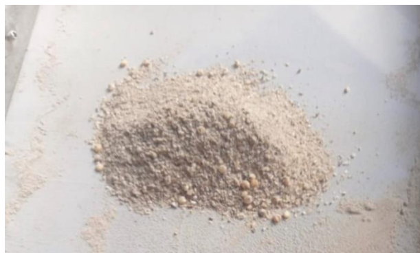
Gambar 4.13 Tepung hasil penggilingan dengan tingkat kehalusan 30 mesh
