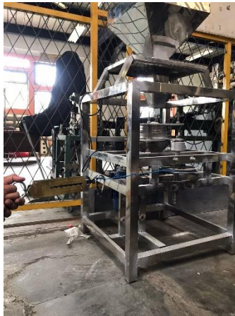
Gambar 4.1 Pengujian dengan neraca pegas
