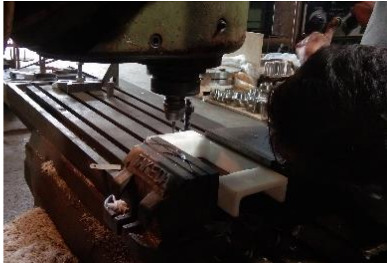
Gambar 4. 41 Proses Drilling dengan diameter lubang 20 mm Pada Modifikasi Pemesinan Milling Dengan 2D Drawing sebagai Gambar Kerja
