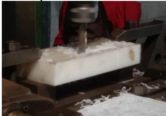
Gambar 4. 47 Endmill Contour Bentuk Persegi Panjang Berfillet R10 180x96 mm Pada Pemesinan Milling Dengan MBD 3D PDF Sebagai Gambar Kerja
