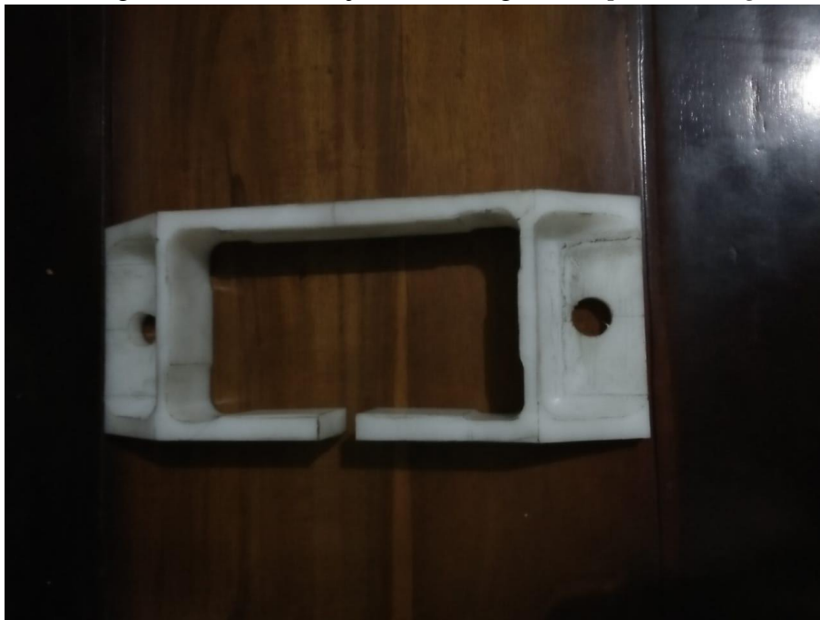
Gambar 4. 44 Benda Kerja Hasil Milling dengan Gambar Kertas sebagai gambar kerja
