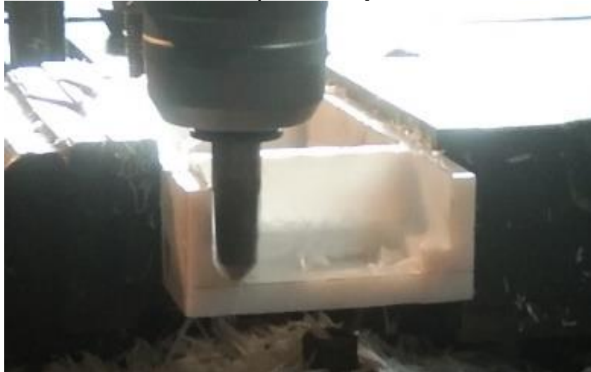
Gambar 4. 35 Contour Fillet R10 Pada Pemesinan Milling Dengan 2D Drawing sebagai Gambar Kerja
