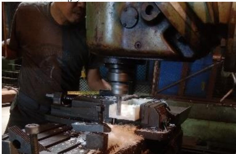
Gambar 4. 40 Proses Memodifikasi ketebalan Sisi kanan dan kiri benda kerja menjadi 12 mm Pada Modifikasi Pemesinan Milling Dengan 2D Drawing sebagai Gambar Kerja
