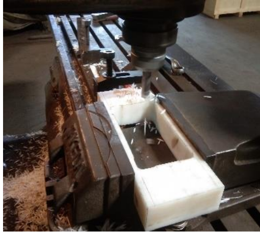
Gambar 4. 32 Contour menuju 184x100 mm Pada Pemesinan Milling Dengan 2D Drawing sebagai Gambar Kerja
