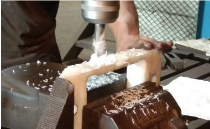
Gambar 4. 43 Posees Memodifikasi Cut menjadi 20 mm Pada Modifikasi Pemesinan Milling Dengan 2D Drawing sebagai Gambar Kerja
