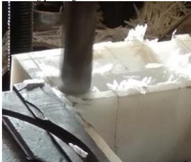
Gambar 4. 49 Endmill Contour Bagian kiri benda kerja Pada Pemesinan Milling Dengan MBD 3D PDF Sebagai Gambar Kerja
