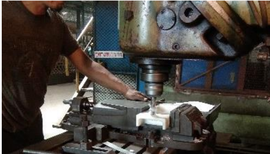
Gambar 4. 36 Proses Drilling Pada Pemesinan Milling Dengan 2D Drawing sebagai Gambar Kerja
