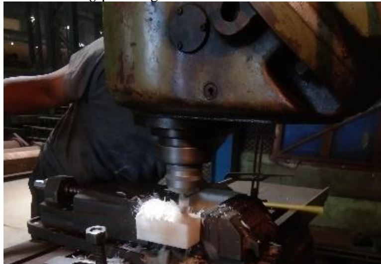
Gambar 4. 33 Endmill bagian kiri kedalaman 25 mm benda kerja Pada Pemesinan Milling Dengan 2D Drawing sebagai Gambar Kerja
