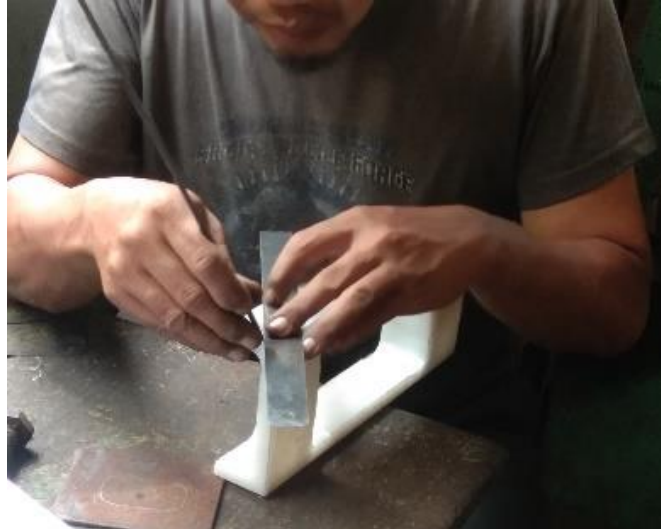
Gambar 4. 38 Proses marking sisi miring Pada Pemesinan Milling Dengan 2D Drawing sebagai Gambar Kerja
