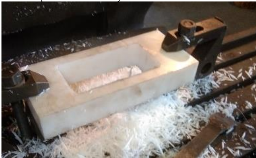
Gambar 4. 31 Contour Persegi Panjang Berfillet R10 180x96 mm Pada Pemesinan Milling Dengan 2D Drawing sebagai Gambar Kerja
