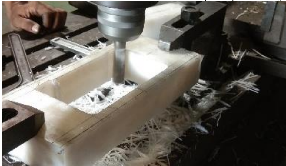
Gambar 4. 48 Endmill Contour menuju 184x100 mm Pada Pemesinan Milling Dengan MBD 3D PDF Sebagai Gambar Kerja
