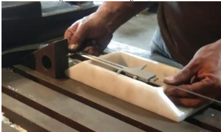
Gambar 4. 39 Proses Marking sebelum melakukan Contour Cut dengan panjang 15 mm Pada Pemesinan Milling Dengan 2D Drawing sebagai Gambar Kerja
