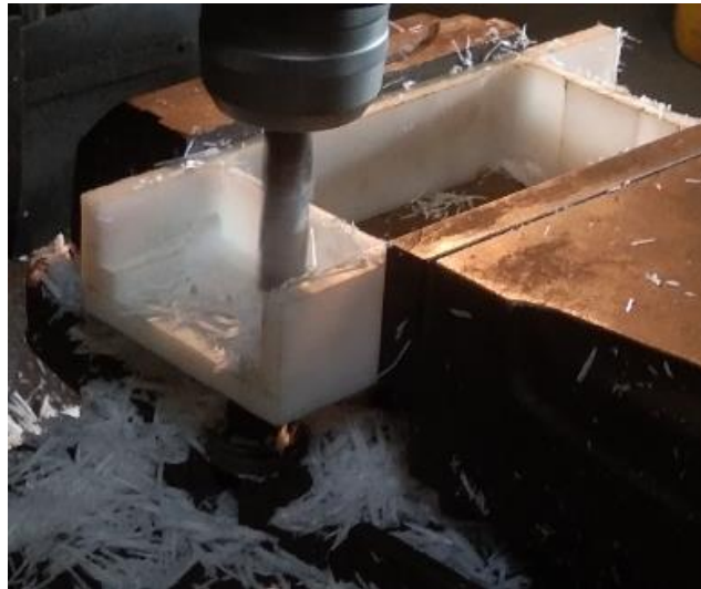
Gambar 4. 34 Endmill Contour Multipass kedalaman 35 mm pada kanan dan kiri benda kerja dengan 2D Drawing sebagai Gambar Kerja.
