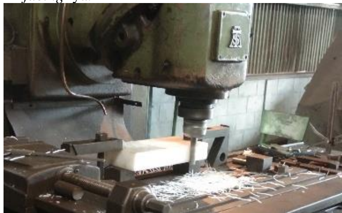
Gambar 4. 46 Proses Contour Facing Bounding Box menuju lebar 125 mm Pada Pemesinan Milling Dengan MBD 3D PDF Sebagai Gambar Kerja
