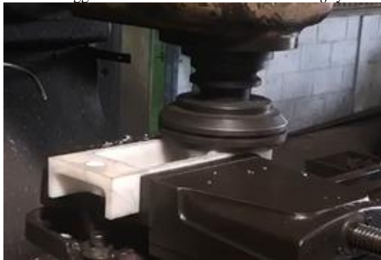
Gambar 4. 37 Proses Facing dengan 2D Drawing sebagai gambar kerja
