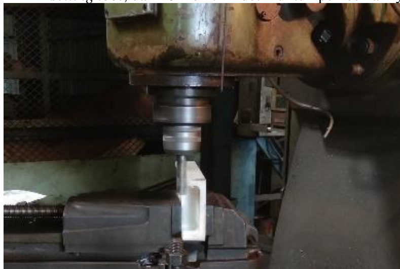
Gambar 4. 42 Proses Memodifikasi Sisi Miring Pada Modifikasi Pemesinan Milling Dengan 2D Drawing sebagai Gambar Kerja
