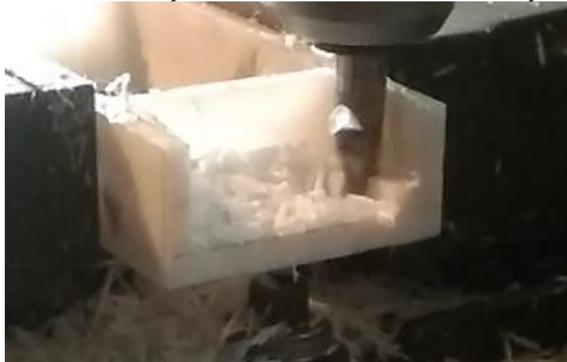
Gambar 4. 50 Contour Fillet R10 Bagia Kanan Benda Kerja Pada Pemesinan Milling Dengan MBD 3D PDF Sebagai Gambar Kerja
