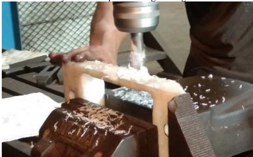
Gambar 4. 51 Proses Modifikasi Cut menjadi 30 mm Pada Pemesinan Milling Dengan MBD 3D PDF Sebagai Gambar Kerja
