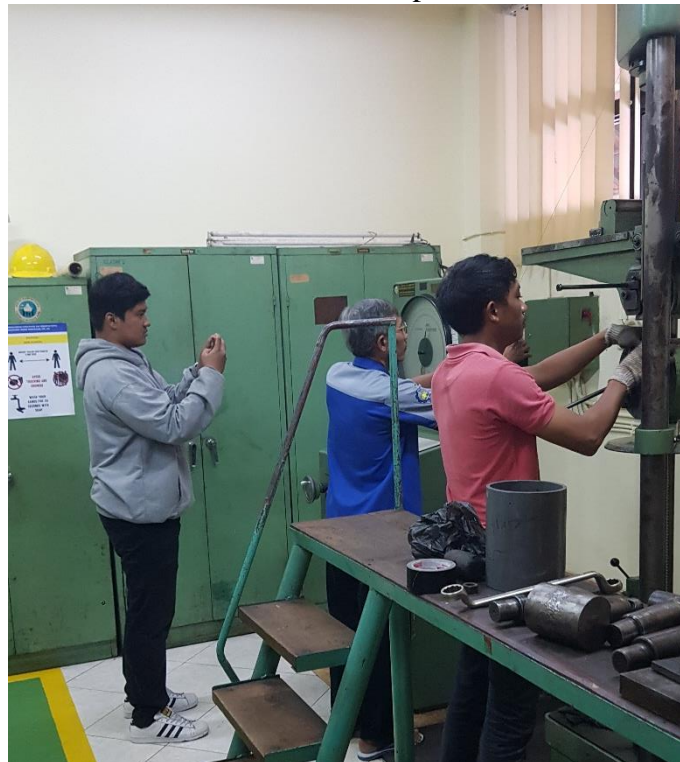
Gambar 4.3 Pemasangan Spesimen Pada UTM
