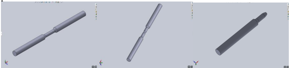
Gambar 4.12 Desain 3D Spesimen Dalam Kondisi Normal, Kondisi Necking, dan Kondisi Putus
