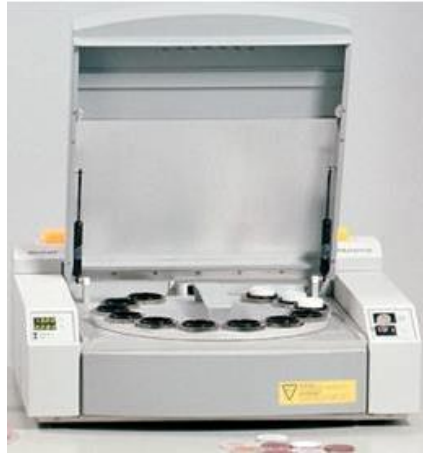
Gambar 3.2 XRF Minipal 4 Tipe PW 1030/45 B (Laboratorium Sentral Mineral dan Material Maju UM)
