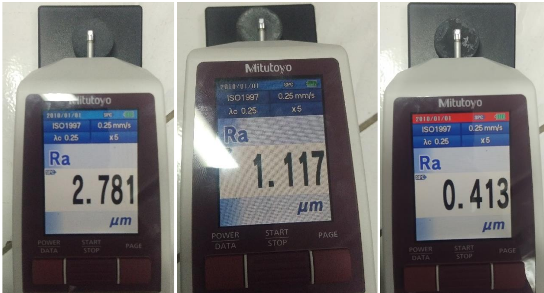
Gambar 4.19 Hasil Pengukuran Kekasaran Permukaan menggunakan Surface Roughness Tester , a) Kompaksi 100 kN, b) Kompaksi 125 kN, dan c) Kompaksi 150 kN
