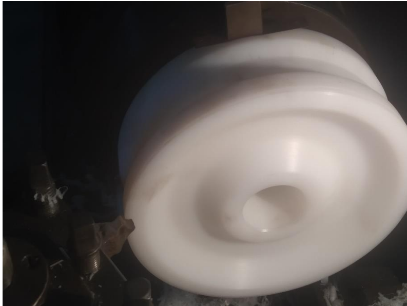
Gambar 4. 59 Proses Facing Fillet R3 mm Pada Mesin Turning Dengan Gambar Kerja 3D PDF
