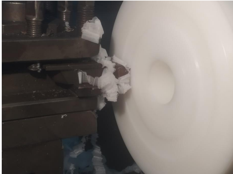
Gambar 4. 57 Proses Facing 68,5 mm Pada Mesin Turning Dengan Gambar Kerja 3D PDF
