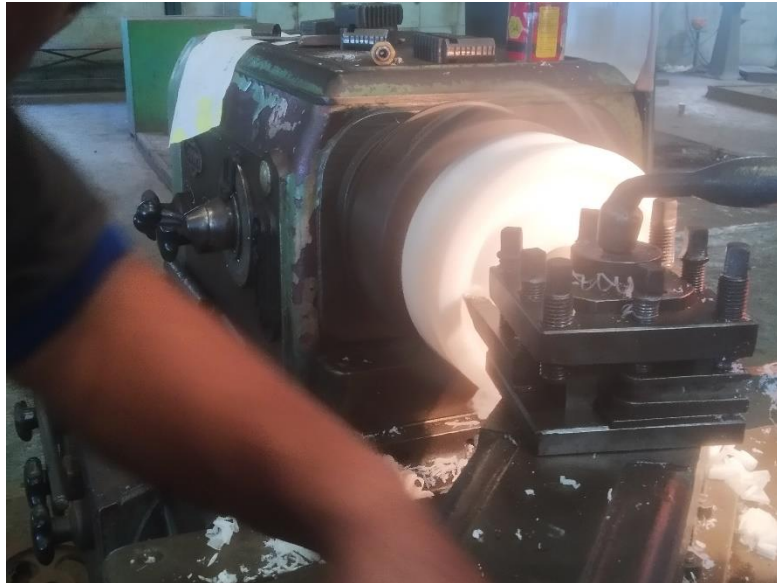
Gambar 4. 48 Proses Facing 57 mm Pada Mesin Turning Dengan Gambar Kerja 2D Kertas
