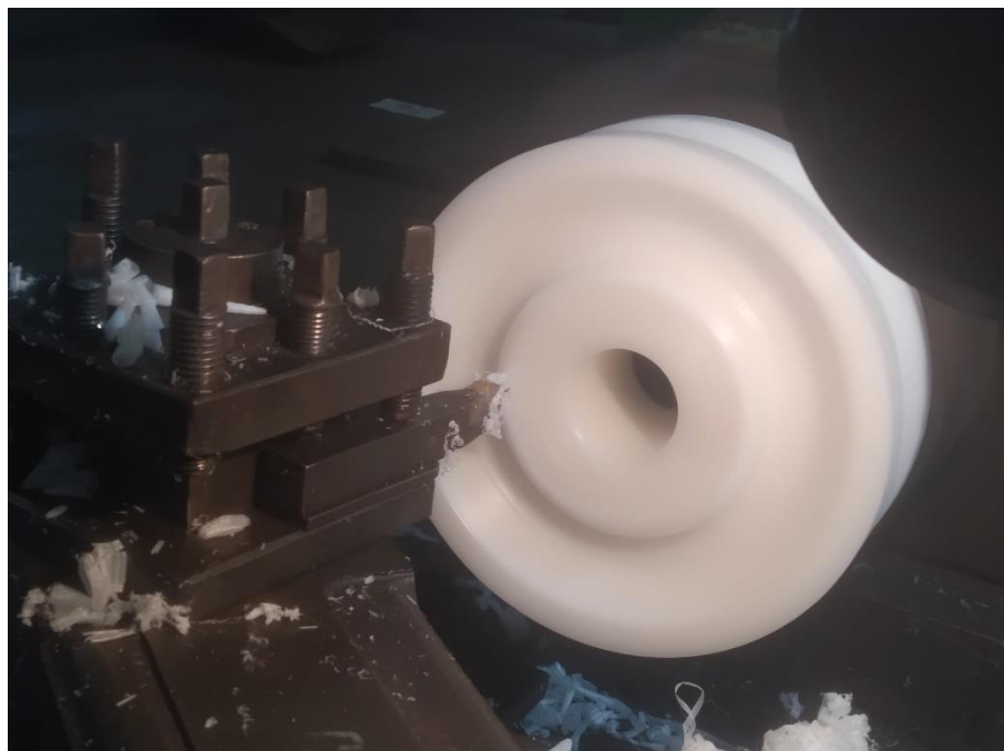
Gambar 4. 62 Proses Facing 46 mm Pada Mesin Turning Dengan Gambar Kerja 3D PDF
