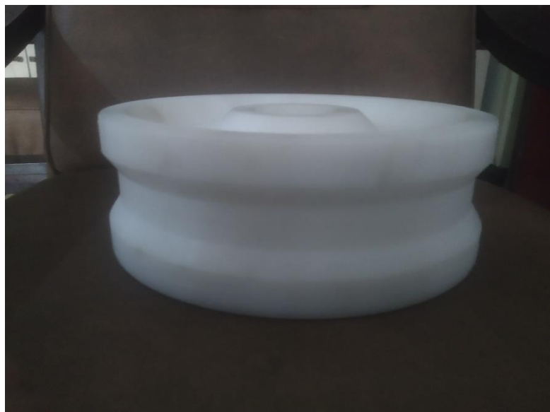
Gambar 4. 66 Benda Kerja Double Wheel Tampak Samping Dengan Gambar Kerja 3D PDF
