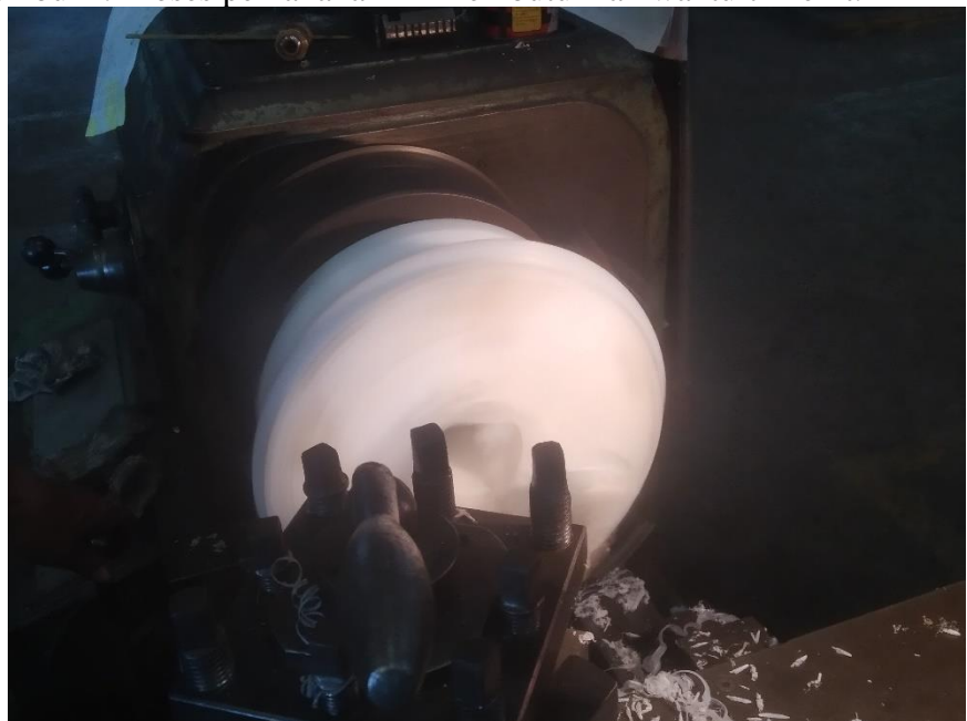
Gambar 4. 43 Proses Roughing Ketebalan 90 mm Pada Mesin Turning Dengan Gambar Kerja 2D Kertas
