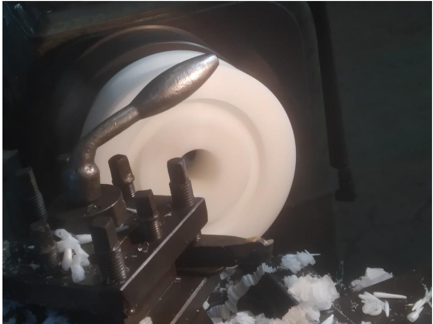
Gambar 4. 61 Proses Facing 56 mm Pada Mesin Turning Dengan Gambar Kerja 3D PDF
