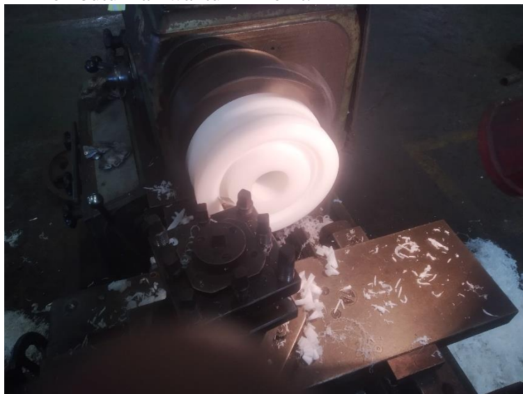
Gambar 4. 45 Proses Facing 68,5 mm Pada Mesin Turning Dengan Gambar Kerja 2D Kertas
