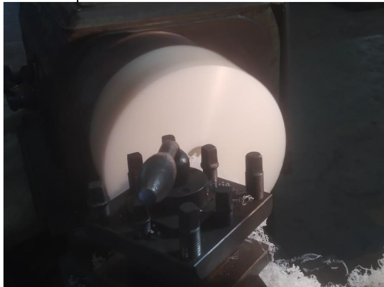
Gambar 4. 55 Proses Roughing Ketebalan 90 mm Pada Mesin Turning Dengan Gambar Kerja 3D PDF
