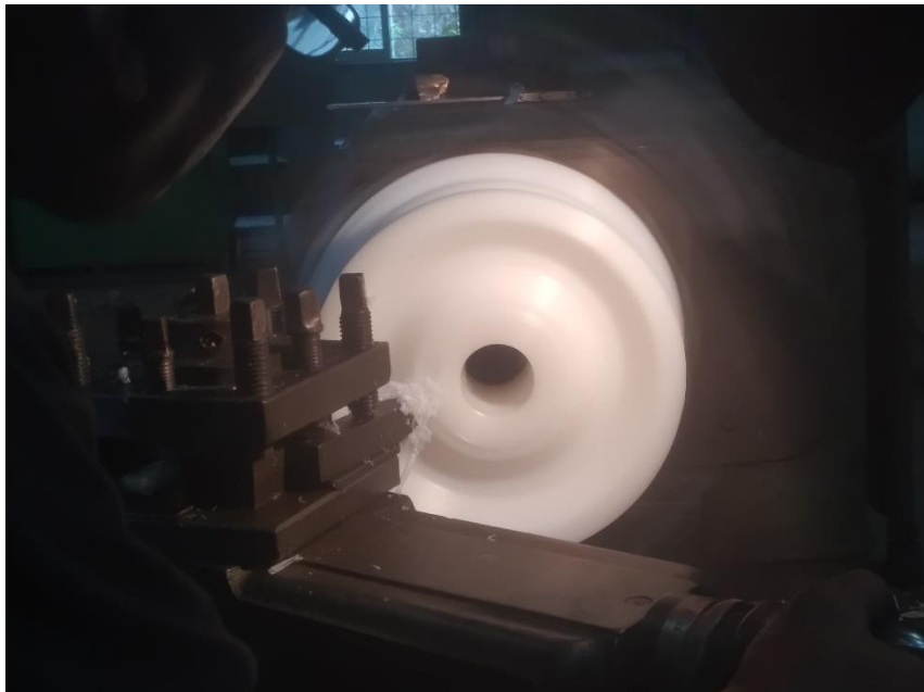
Gambar 4. 58 Proses Facing 68,5 mm Pada Mesin Turning Dengan Gambar Kerja 3D PDF
