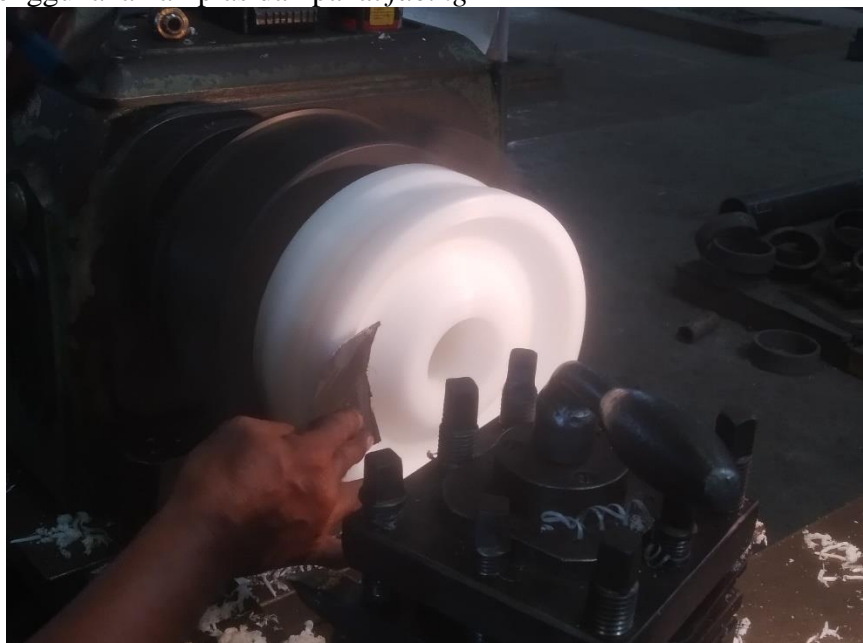
Gambar 4. 49 Proses Finishing Pada Mesin Turning Dengan Gambar Kerja 2D Kertas
