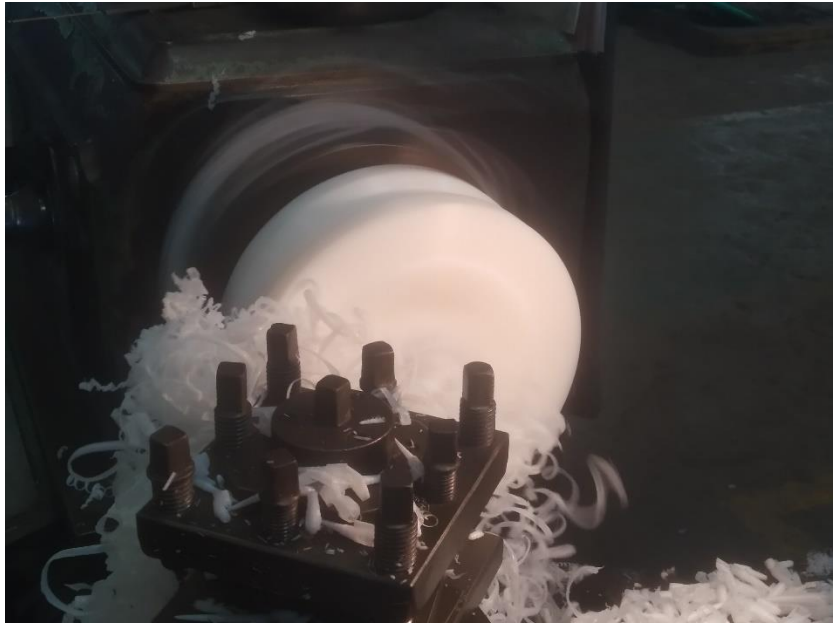
Gambar 4. 42 Proses Roughing Diameter Luar 225 mm Pada Mesin Turning Dengan Gambar Kerja 2D Kertas
