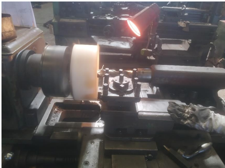
Gambar 4. 53 Proses Drilling 40 mm Pada Mesin Turning Dengan Gambar Kerja 3D PDF
