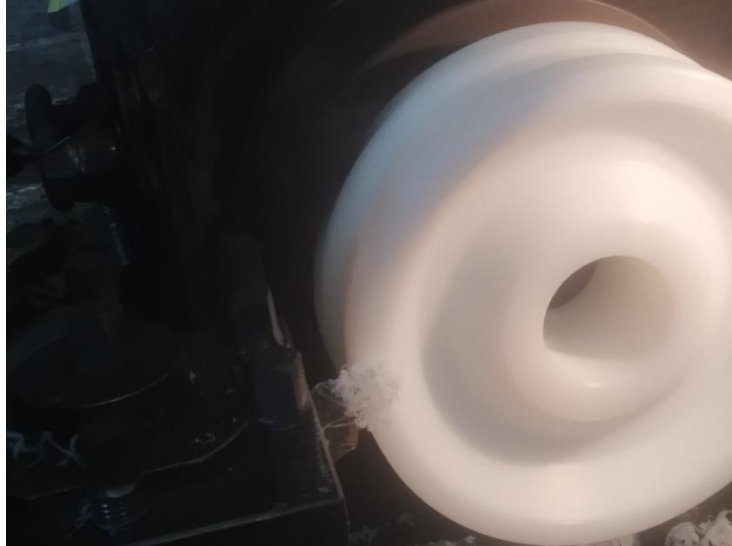
Gambar 4. 46 Proses Facing Fillet R3 mm Pada Mesin Turning Dengan Gambar Kerja 2D Kertas
