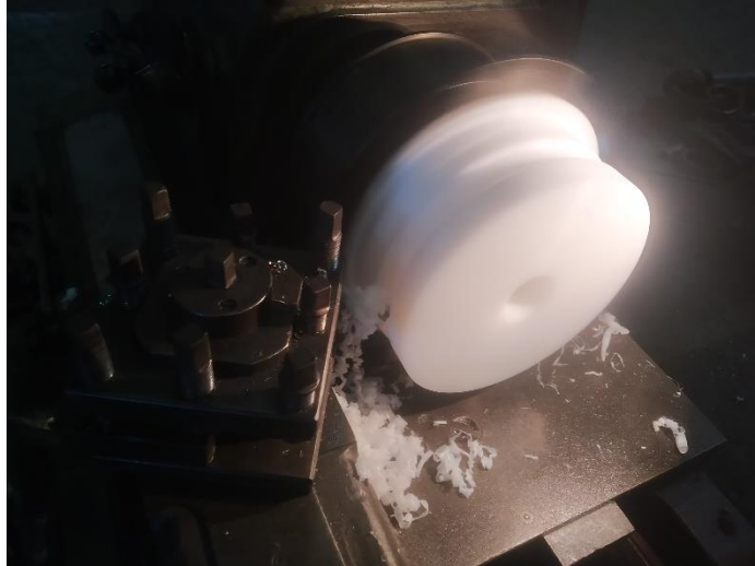
Gambar 4. 56 Proses Facing Diameter 216 mm Pada Mesin Turning Dengan Gambar Kerja 3D PDF
