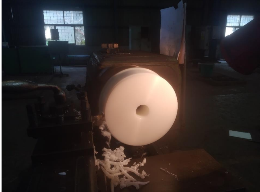
Gambar 4. 54 Proses Roughing Diameter Luar 230 mm Pada Mesin Turning Dengan Gambar Kerja 3D PDF
