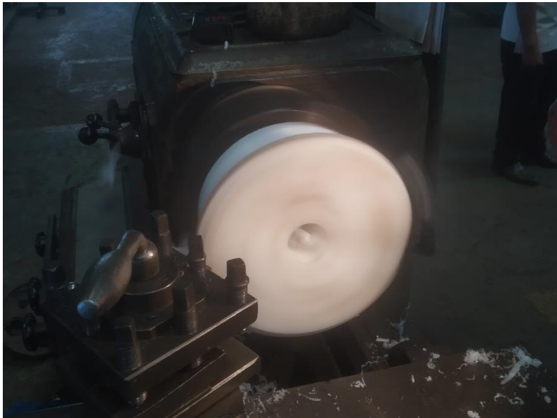
Gambar 4. 60 Proses Roughing Ketebalan 80 mm Pada Mesin Turning Dengan Gambar Kerja 3D PDF
