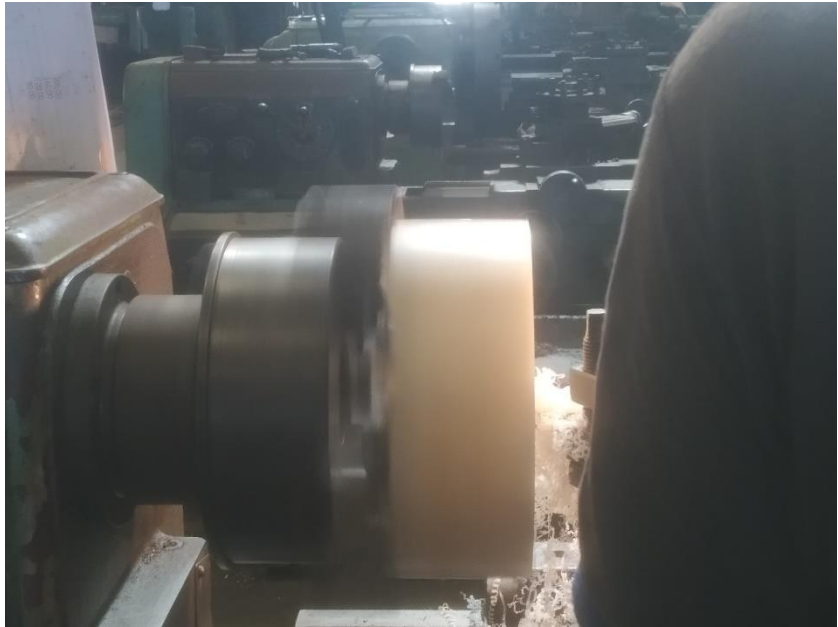
Gambar 4. 63 Proses Facing Chamfer 1 mm Pada Mesin Turning Dengan Gambar Kerja 3D PDF
