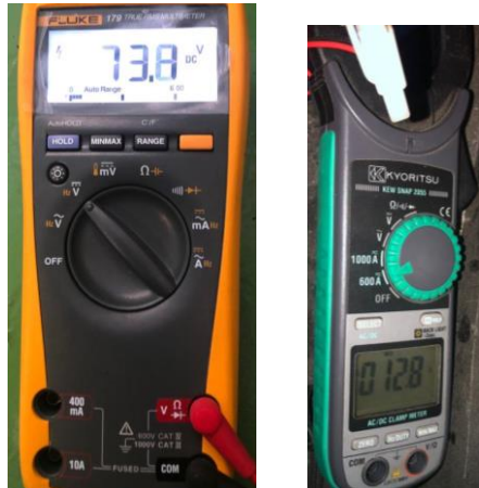
Gambar 4.3 Pengukuran Voltase dan Ampere pada Baterai Mobil Formula EV Anargya ITS Mark 2.0
