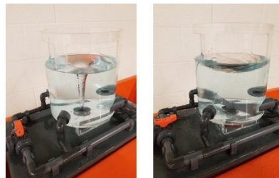
Gambar 2.1 (a) aliran vortex bebas, (b) aliran vortex paksa (uta.pressbooks.pub)
