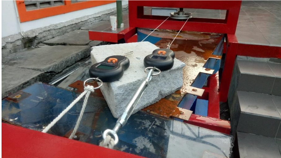
Gambar 3.11 Metode Pengukuran Torsi
