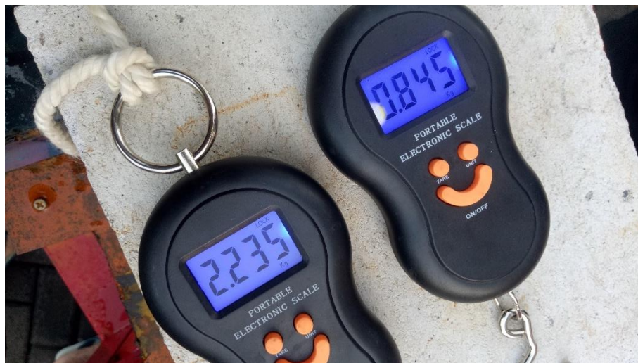
Gambar 3.12 Pembacaan Beban Pengereman pada Neraca
