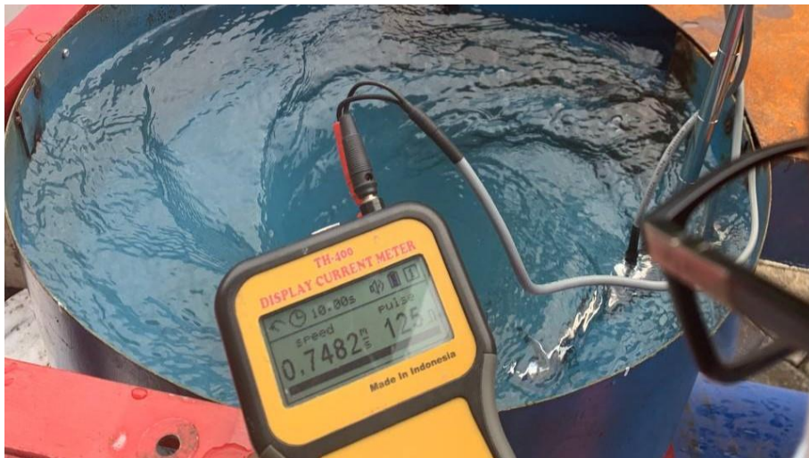
Gambar 3.14 Metode Pengukuran Kecepatan Aliran
