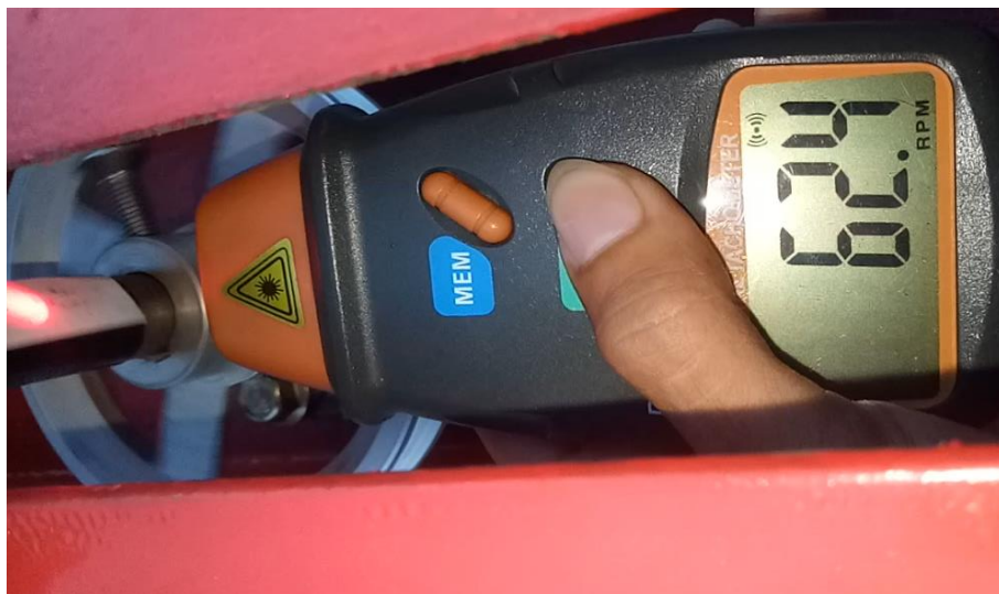
Gambar 3.10 Metode Pengumpulan Data Putaran Turbin
