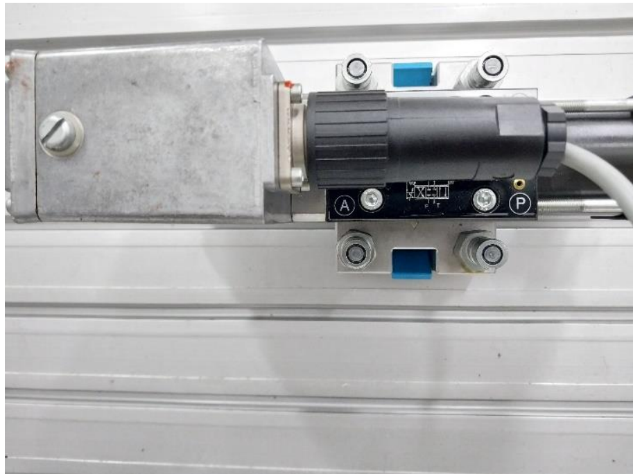
Gambar 4. 5 Lubang A Pada Katup Servo
