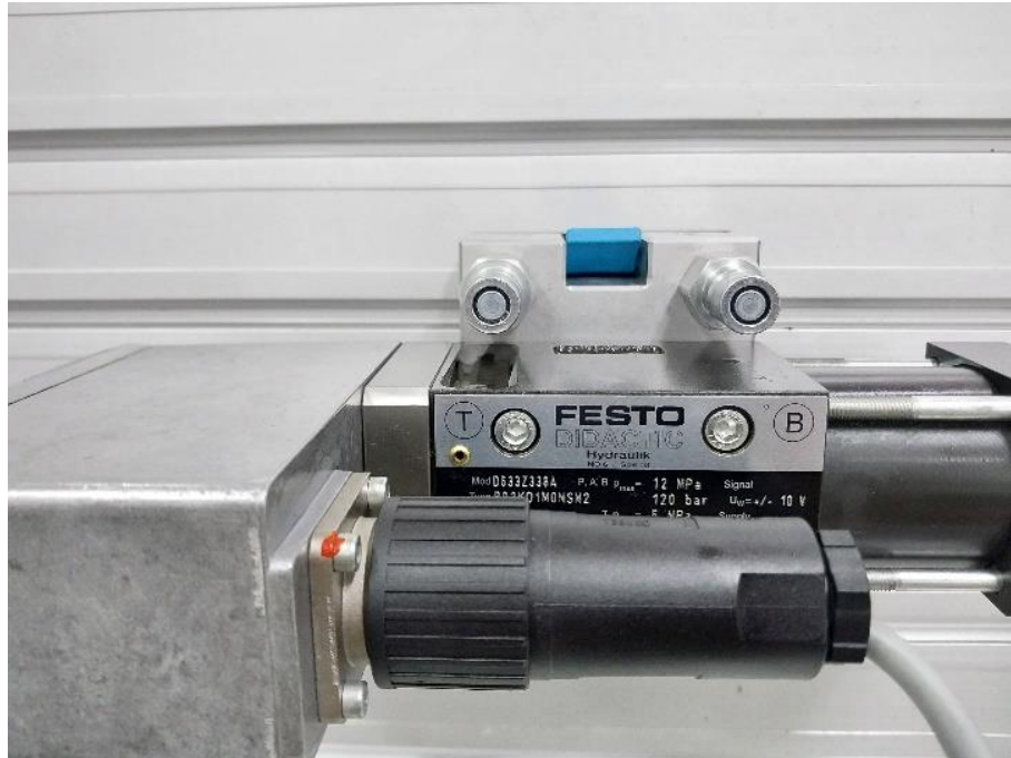
Gambar 4. 6 Lubang B Pada Katup Servo
